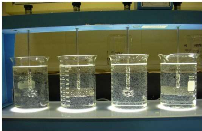
Figure III-8 : Photographie de l'appareil de jar test .
