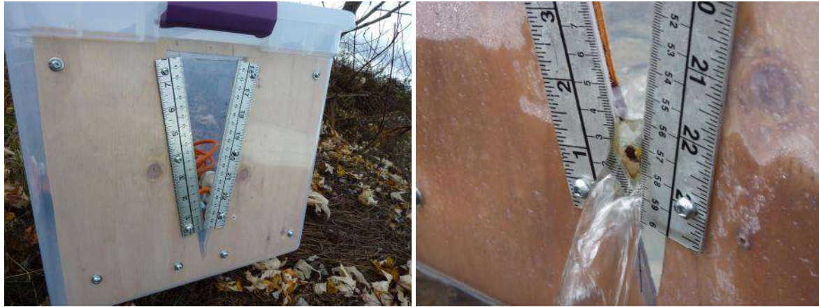
Figure 22 - Bac avec déversoir en V
