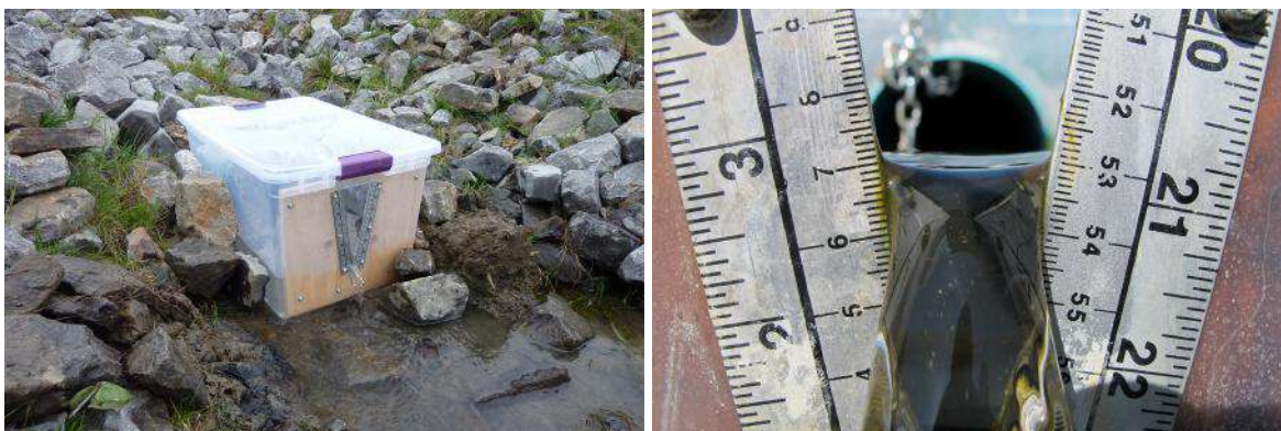
Figure 24 - Bac avec déversoir installé.
